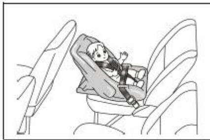
Если установка детской удерживающей системы мешает механизму блокировки передних сидений, ее нельзя устанавливать на второй ряд сидений. В противном случае, это может привести к смерти или серьезной травме младенца и переднего пассажира в случае резкого торможения или столкновения.
