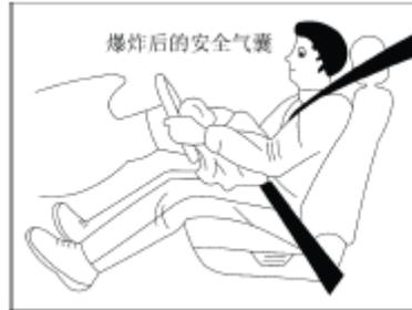
5 Система защиты подушки безопасности может дополнительно улучшить защитный эффект ремня безопасности, предотвращая столкновение головы и груди водителя и переднего пассажира с внутренними компонентами, но она не может заменить ремень безопасности, а играет только вспомогательную защитную роль.
