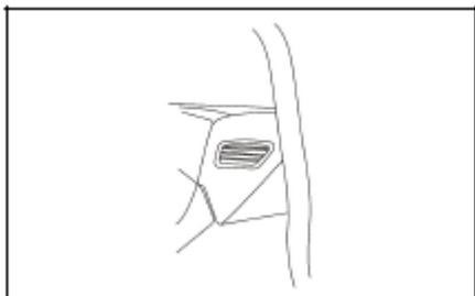
**Вентиляционное отверстие обдува лица на приборной панели**
