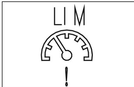
Если после активации этой функции скорость автомобиля превышает предельное значение, надпись LIM 80 km/h на комбинации приборов становится красной и начинает мигать. Одновременно с этим срабатывает зуммер.
