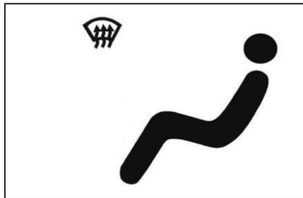
Если система кондиционирования отключена, то при нажатии этой кнопки система включается и переходит в режим обогрева ветрового стекла. При повторном нажатии кнопки система возвращается в рабочее состояние, которого предшествовало отключению системы (кроме режимов обогрева ветрового стекла и максимального охлаждения/обогрева).
