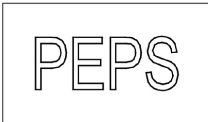
**Сигнализатор неисправности электронной блокировки рулевой колонки**
