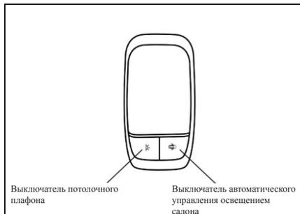
Нажмите выключатель потолочного плафона для включения плафона освещения салона. Нажмите выключатель еще раз для выключения потолочного плафона.
