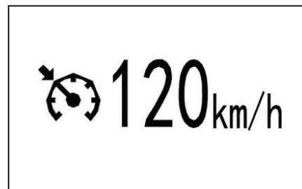
**Индикатор включения ограничителя скорости и установки скоростного ограничения (модели в улучшенной комплектации)**
