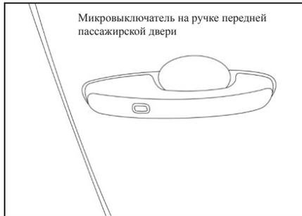
После закрывания всех дверей нажмите кнопку микровыключателя, чтобы одновременно запереть все двери автомобиля. При этом все указатели поворотов мигнут один раз.
