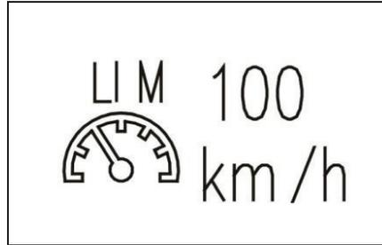
**Сигнализатор неисправности регулируемого ограничителя скорости (модели в улучшенной комплектации)**
